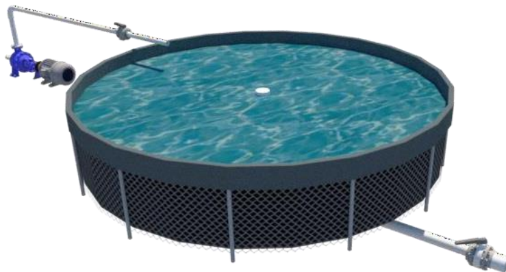
Figura 02 - Modelo em 3D de tanques suspensos utilizados no projeto, mostrando entrada de água por bombeamento e saída pelo sistema overflow.
